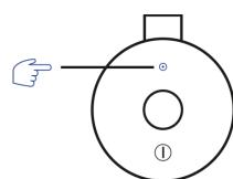
Натиснете и задръжте Bluetooth® бутона, за да превключите в режим на свързване. Отидете в Bluetooth® менюто на у-вото и изберете MEGABOOM 3. Ще чуете звуков сигнал от тонколоната след като бъде извършена връзка.
